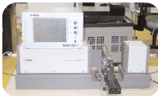
Auswerteeinheit 382-Z mit Lasersensor 1504
