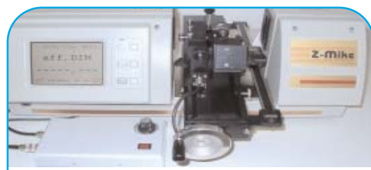
Verschiebeschlitten, Länge 460 mm, Serie 1200 mit Spindel und Maßstab
